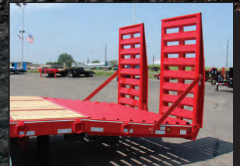
Angle iron ramps - 22", 30", 38", 45" x 6'
